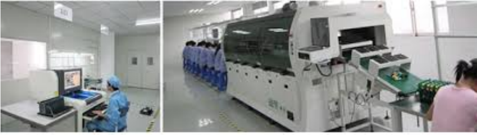
Stýring monterast á printplátur í framleiðsluni við “wave soldering”. Mynd: MAGNA
