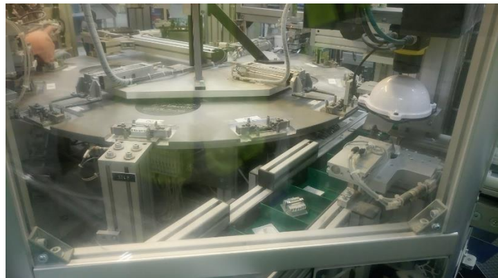
Figur 10. Vísir ein maskinu í framleiðsluhøllin sum er í gongd við at samla stikkkontaktir.
